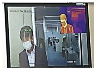
※固定カメラタイプ使用時 PCモニターの測温表示イメージ
